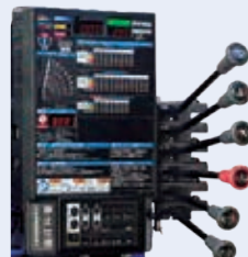
Photo: 操作レバーと集中コントロールパネル (本体右サイド)
